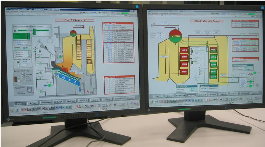
Prozessbilder von Ofen 2; links die Übersicht und rechts das Verfahrensschema für Wasser und Dampf.
