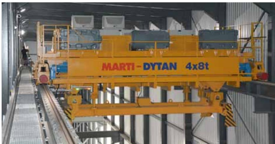
Funkgesteuerter Containerkran mit frequenzregulierten Antriebsmotoren
