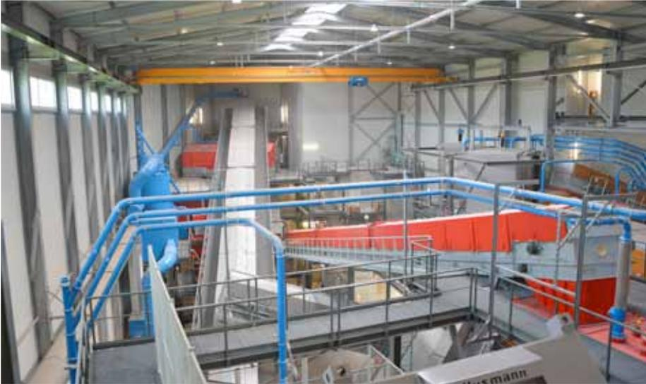
Triagehalle mit diversen Förderbändern und Entstaubungsanlage (blau gefärbt)
